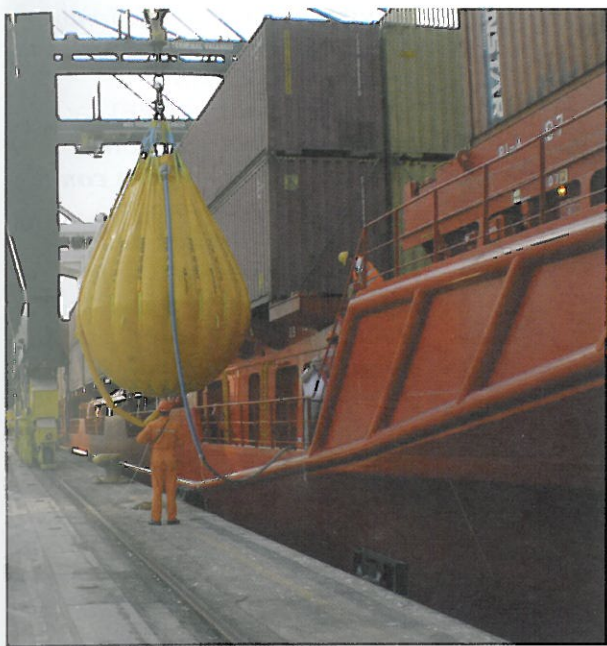
Primera vez que se utilizó una prueba de carga de 20 toneladas en el buque Eemsdijk atracado en una de las terminales que tiene el Puerto de Valencia.
