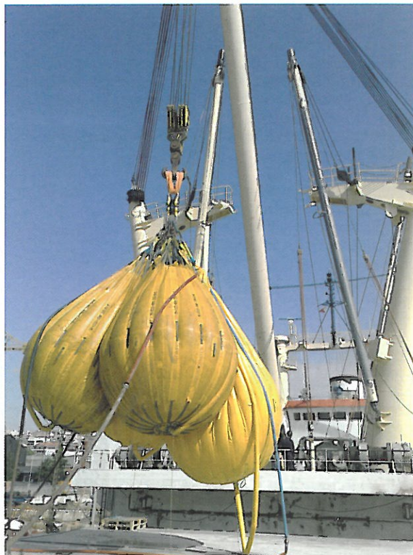
Prueba de carga de 88 toneladas en el buque IBN SINA II en los astilleros de Navalrocha en Portugal.
